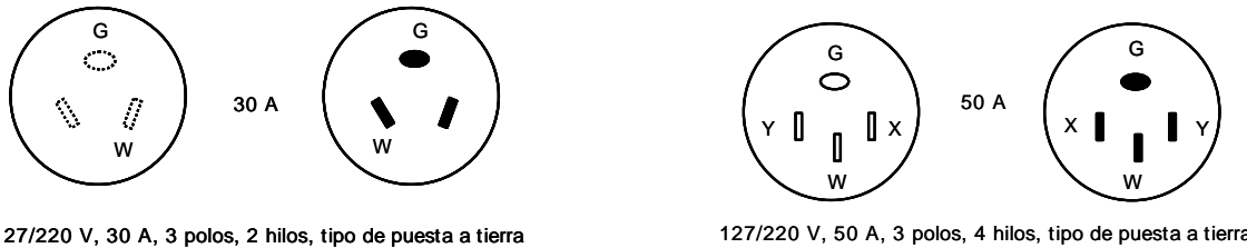
FIGURA 552-44(c).- Configuraciones para contactos y clavijas del tipo con puesta a tierra
